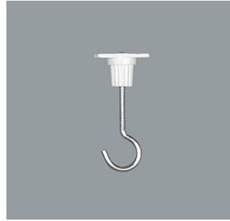
79527.000 Display hook Polymer/steel. Load: 10kg. L 67mm.
